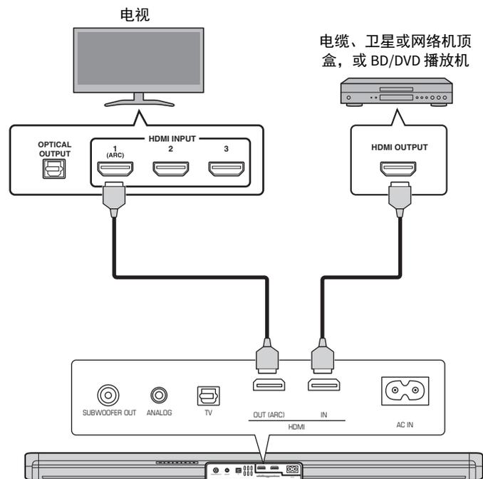
如果要连接支持音频回传通道（ARC）的电视，当如上所示进行连接时条形音箱仅可以播放电视的音频。
